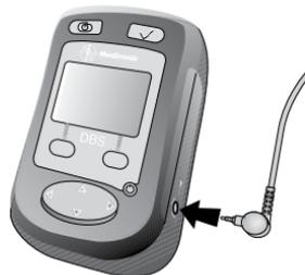
**Nota:** La antena es opcional. Para utilizar el programador sin la antena, coloque el programador sobre el neuroestimulador con la pantalla hacia afuera.
